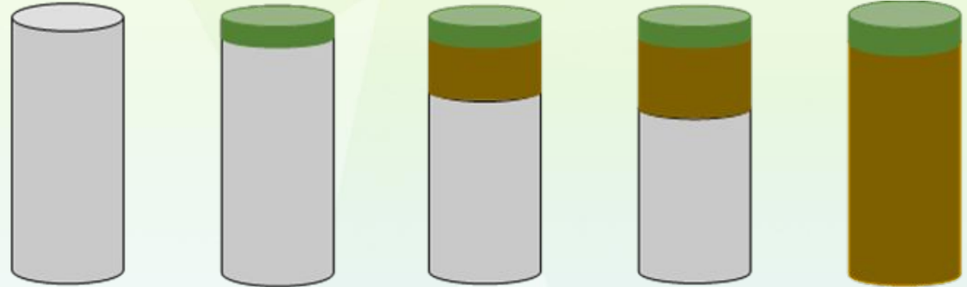
90 cm CM Tailings 5 cm PMM 85 cm CM tailings 5 cm PMM 15 cm Till 70 cm CM tailings 5 cm PMM 35 cm Till 50 cm CM tailings 5 cm PMM 85 cm Till
